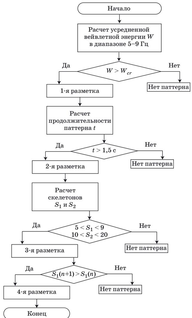
■ **Рис. 3.** Блок-схема разработанного алгоритма для автоматического обнаружения проэпилептических паттернов на ЭЭГ
