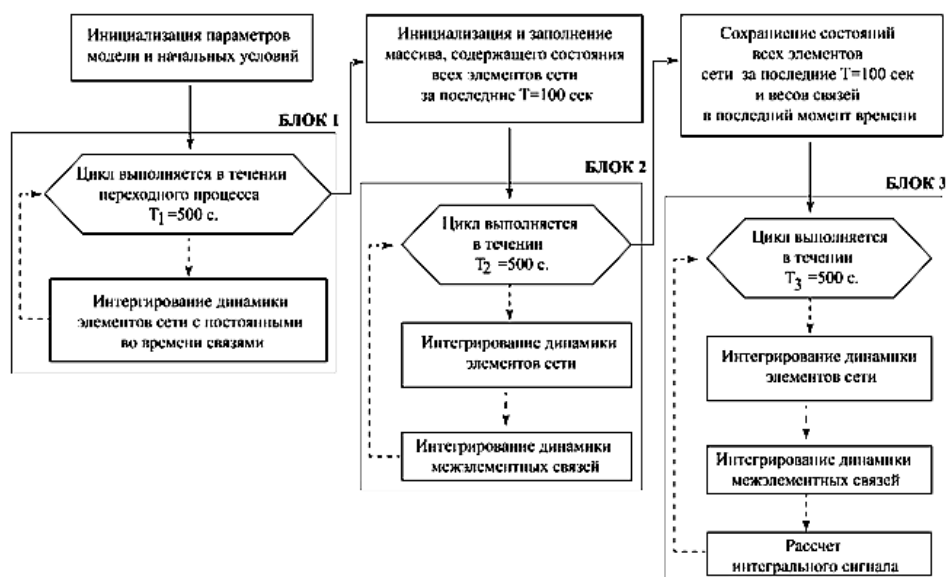
Рисунок 3 – Функциональная схема взаимодействия подпрограмм в программном комплексе, осуществляющем расчет интегрального сигнала в сети осцилляторов с изменяющимися во времени весами связей. Штриховыми линиями показаны участки программы, выполняемые в цикле
