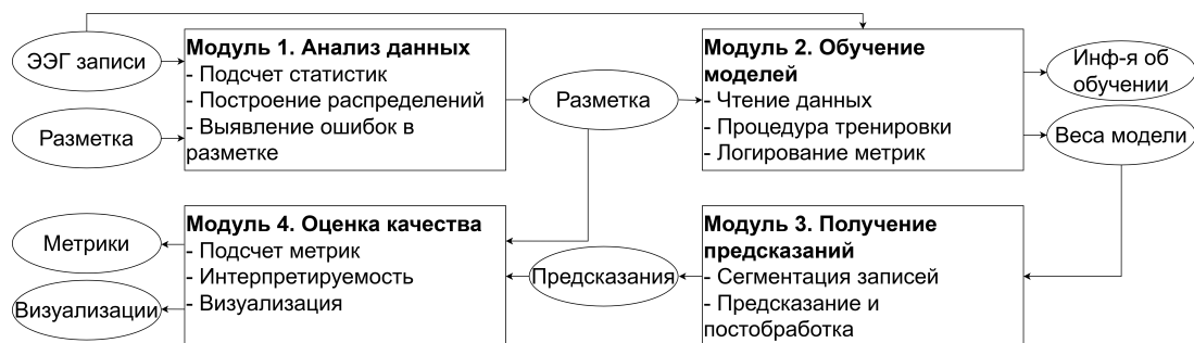
Рис. 6: Общая схема комплекса программ для построения моделей для выявления эпилептических приступов и разметки многоканальных записей ЭЭГ
